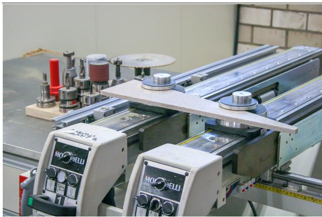
Mechanische Spanner VCMC-S4 beim Aufspannen von Holzteilen
